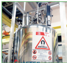
1 THz ジャイロトロン FU CW III 20 T 超伝導マグネット
