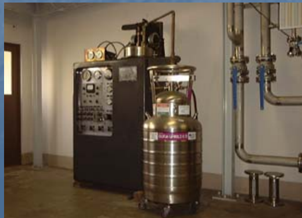
ADL社のコリンズ型液化機 東北大学設置された日本初のヘリウム液化機 東北大 金研より
