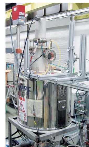
12 T の超伝導マグネットに搭載された高出力パルスジャイロトロン。大型ヘリカル装置 LHD (核融合科学研究所) への適用を目標に開発中
