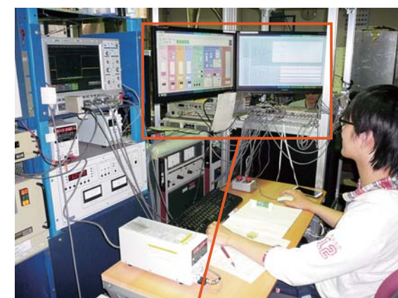
コンピュータ制御によるジャイロトン運転装置
