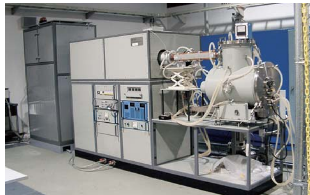
28 GHz/15 kW 高出力電磁波照射装置
