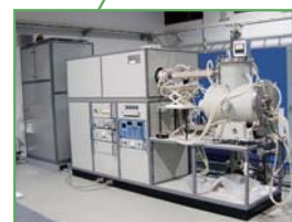
28 GHz セラミック焼結装置
