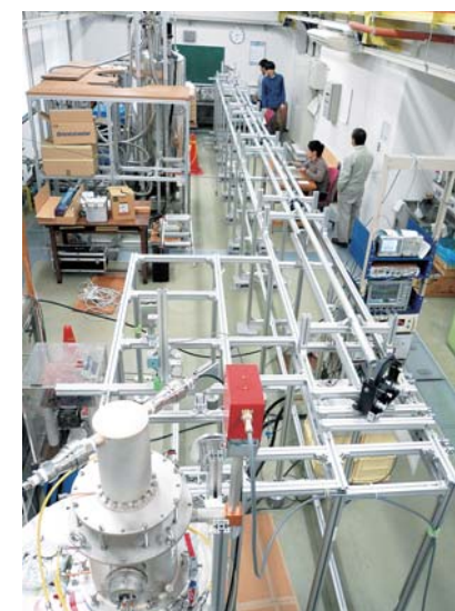
ジャイロトロン出力の長距離伝送実験の様子
